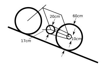
a) Der Pedalarm hat eine Länge von 17cm, das vordere Kettenblatt einen Durchmesser von 20cm, der hintere Zahnkranz 10cm und der Hinterreifen einen Durchmesser von 60cm. Welche Käfte, bzw. Drehmomente sind bei statischem Gleichgewicht äquivalent? Nutze diese Informationen um einen Ausdruck für den Winkel des Hangs zu finden, wenn das Gewichts des Fahrrads vernachlässigt werden kann.
